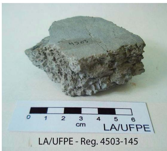
Figura 120 – Fragmento de cimento apresentando acabamento alisado em uma das faces.
